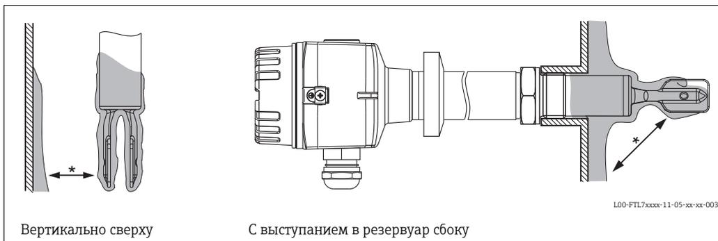
**Монтажные положения при низкой вязкости (до 2000 мм<sup>2</sup>/с (сСт)):**
